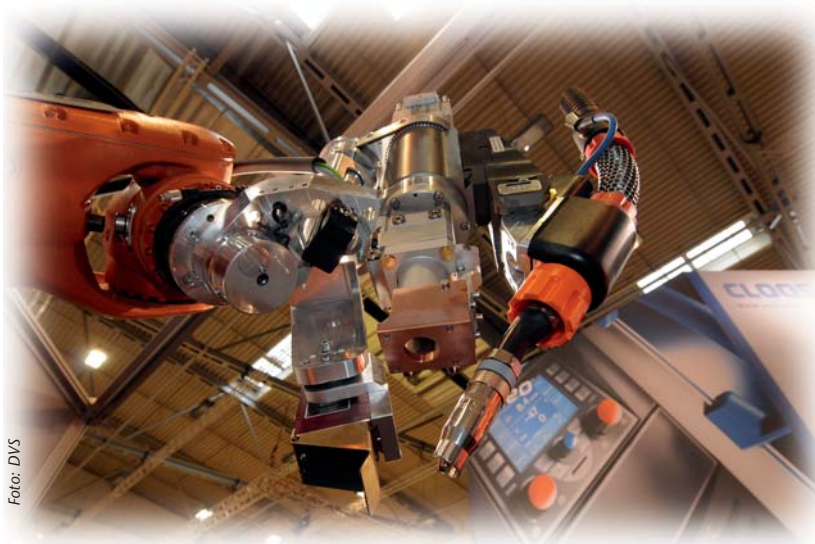
Innovatives Messe-Exponat: Laser-Lichtbogen-Hybridschweißgerät
