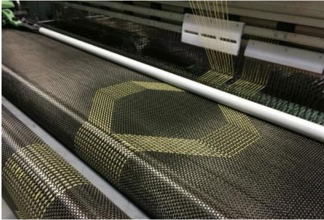
Produktionsprozess des Open Reed Weaving: Einweben von Aramidfäden (gelb) in Carbonschwarzgewebe
